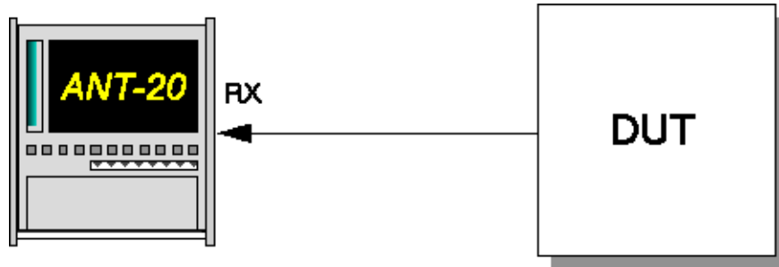
Bild A-68 Meßaufbau für Phasehit-Messungen
